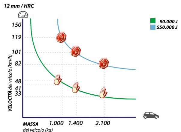
Diversi fattori quali l'indice di compattazione, il coefficiente di permeabilità del terreno e il tipo di calcestruzzo possono ridurre anche notevolmente i valori indicati nel grafico.
