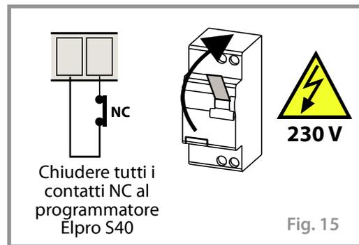
[C] Verificare i collegamenti elettrici ai finecorsa. Data alimentazione elettrica, controllare prima di tutto lo stato dei led: con la colonna abbassata il led L8 è SPENTO, mentre il led L9 ACCESO. Se questo non succede, invertire i collegamenti sui morsetti 11 e 12 dell'Elpro S40.
