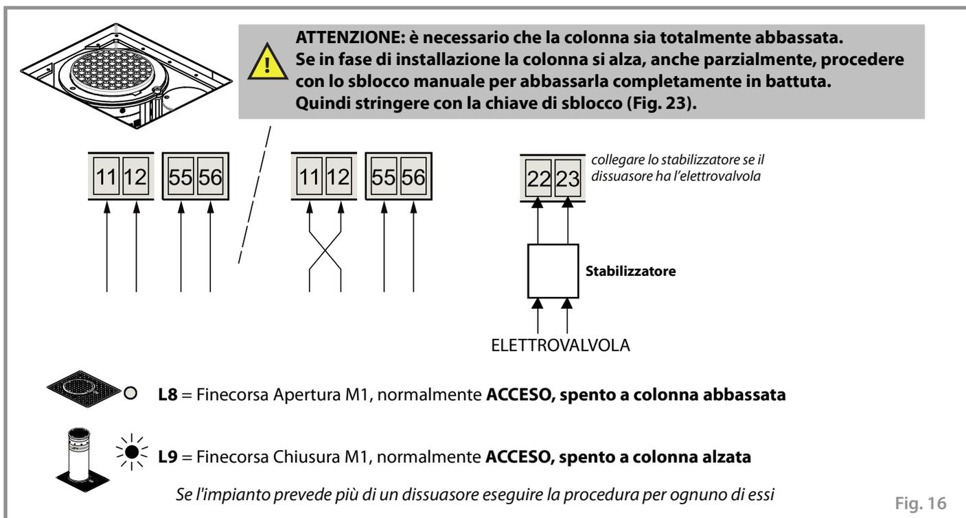
[B] Data alimentazione elettrica, se i led dei finecorsa sono accesi correttamente (colonna abbassata led L8 è SPENTO), al primo impulso di comando la colonna deve alzarsi. Altrimenti invertire le fasi dei morsetti del motore (sull'Elpro S40) dopo aver tolto alimentazione elettrica all'impianto.
