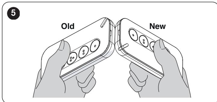
2. Sul NUOVO trasmettitore (New), tenere premuto un tasto qualsiasi, all'interno del settore desiderato, fino a quando il led (A) del VECCHIO trasmettitore (Old) si accende. Quindi, rilasciare il tasto (il led (A) del VECCHIO trasmettitore (Old) inizia a lampeggiare).
