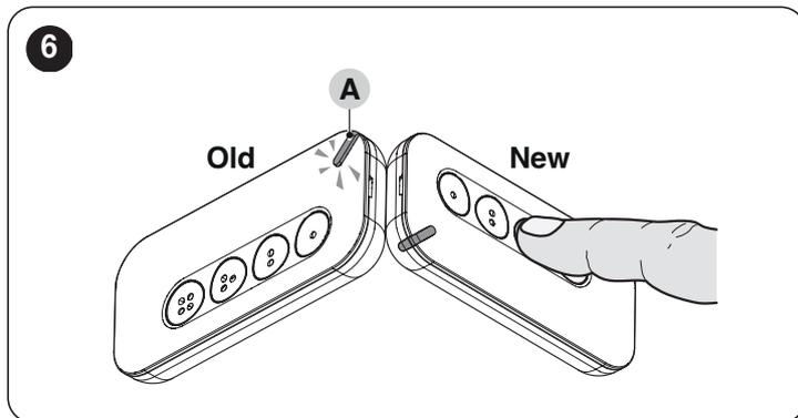
3. Sul VECCHIO trasmettitore (Old), tenere premuto un tasto qualsiasi, all'interno del settore desiderato, fino a quando il led (B) del NUOVO trasmettitore (New) si accende. Quindi, rilasciare il tasto (il led (B) del NUOVO trasmettitore (New) si spegne, segnalando il termine della procedura e l'avvenuto trasferimento del "codice di abilitazione" nel NUOVO trasmettitore).
