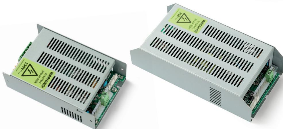
INIM dispone di due alimentatori/caricabatteria con tecnologia switching, il modello da 3A e il modello da 5A. Tutti i modelli sono provvisti di un ingresso per una sonda termica. Questo dispositivo protegge le batterie dal surriscaldamento e dal successivo danneggiamento tramite la misurazione della temperatura delle batterie e la conseguente regolazione della loro tensione.
