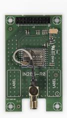
Il modulo opzionale PrimeWiFi permette di dotare le centrali della linea Prime di connettività Wi-Fi. Si innesta sulla scheda principale della centrale Prime e fornisce alla centrale una connessione wireless alla rete Wi-Fi domestica o aziendale. La connettività alla rete permetterà all'installatore la programmazione da remoto e la supervisione dell'impianto utilizzando il software Prime/STUDIO e la connessione al Cloud INIM.
