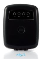
I lettori di prossimità sono il modo più semplice per interagire con il sistema antintrusione INIM. Semplicemente avvicinando il tag o la card al lettore è possibile impartire comandi al sistema.
