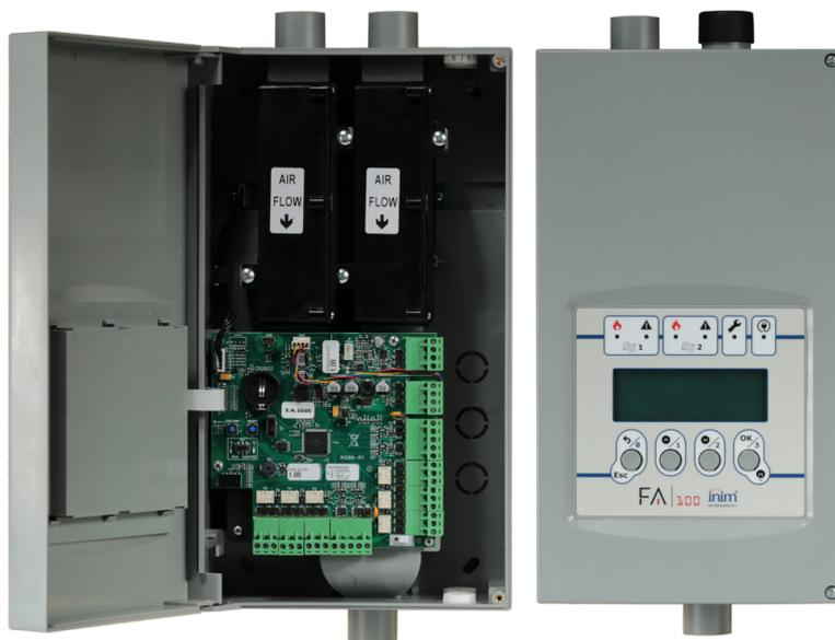
Il rivelatore può essere abbinato alle centrali rivelazione incendio indirizzate Inim collegandolo direttamente sul loop (fornendo comunque la tensione di alimentazione separata) e trasferendo in questo modo tutte le segnalazioni e i controlli in centrale, oppure può essere abbinato a qualsiasi centrale, anche convenzionale, grazie alle sue uscite relè (6) e i suoi morsetti di ingresso e uscita I/O (4).
