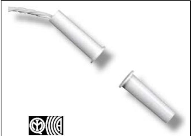
Contatto magnetico da incasso corpo plastico bianco. Note per l'installazione: Adatto per installazioni su serramenti non ferromagnetici. Dove possibile si raccomanda di installare alla distanza di 5mm in linea con l'asse principale Y. Diametro di foratura 9mm; profondità 32mm.
