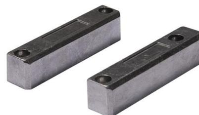
Contatto magnetico per superficie di grande portata. Contatto N.C. con anta chiusa. Contenitore in alluminio pressofuso di elevata resistenza per l'installazione e su porte ferromagnetiche e non. Disponibile anche nella versione con contatto in scambio. Nella confezione sono inclusi tappi anti-rimozione delle viti di fissaggio. Collegamento con morsetti per contatto di allarme e tamper
