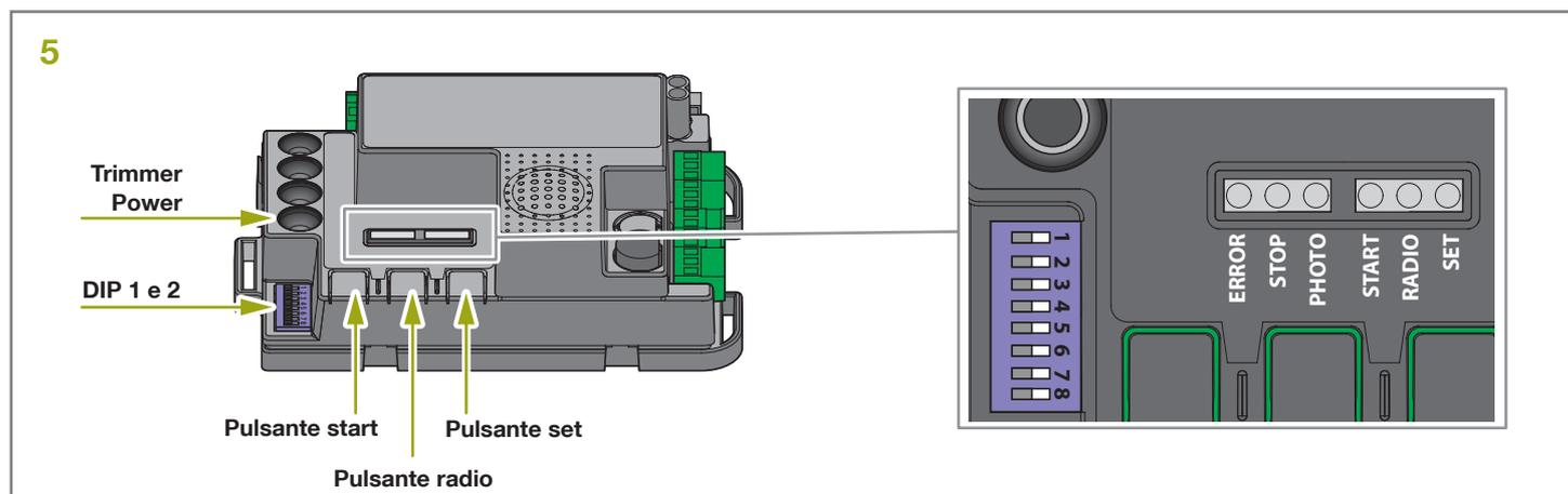
Per la messa in servizio dell'impianto è necessario eseguire una delle seguenti programmazioni:
