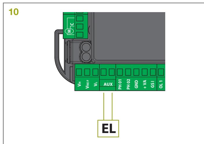
**⚠ Nel caso di presenza di un elettroserratura può essere utile attivare il colpo d'ariete posizionando il dip 8 in ON.**
