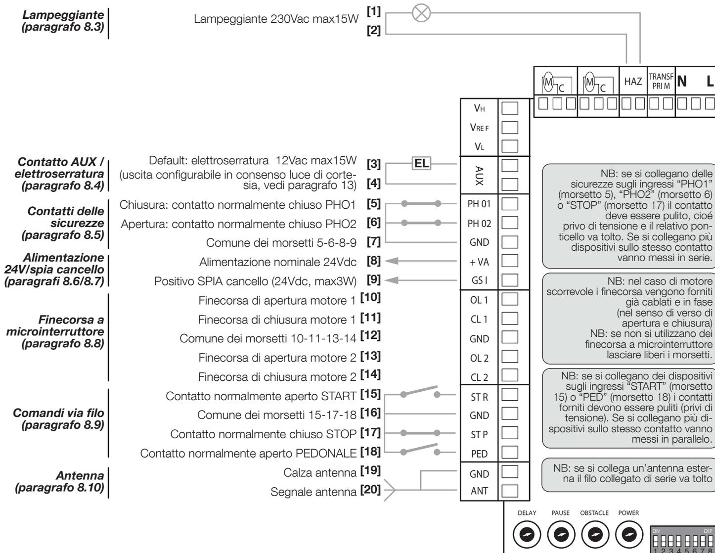
**⚠ FUNZIONE AZIENDALE:** se ad automazione chiusa viene premuto e mantenuto chiuso il contatto di START (ad esempio con un relé temporizzato o bistabile), la centrale esegue l'apertura e l'automazione non accetta comandi di chiusura (né automatica, né via filo) finché il contatto non viene riaperto. Solitamente in questa modalità si posiziona il dip3 STEP in OFF e il dip4 AUTO in ON per assicurarsi che il cancello non resti mai bloccato in apertura.
