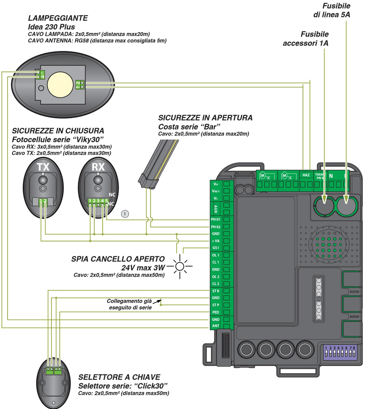
① Se si desidera far lavorare le fotocelle in apertura invece che in chiusura, collegare il filo "1" al morsetto "PHO2" e porre il dip5 in ON.
