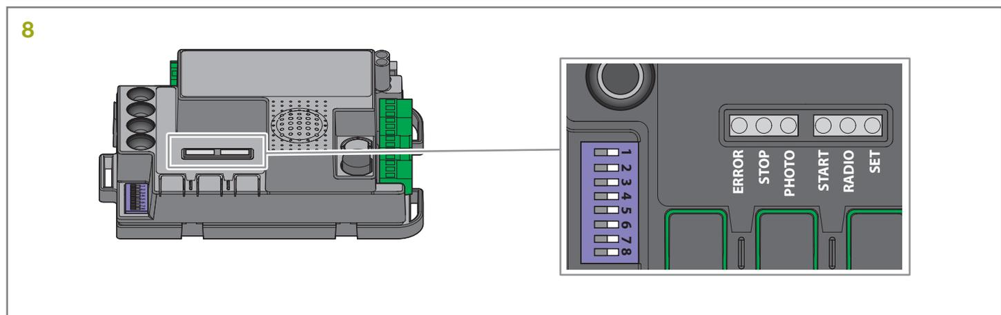
La centrale dispone di 6 led di segnalazione. A centrale alimentata (se non è attiva la protezione della centrale) il led giallo **Set** lampeggia per 5 secondi e, se tutto è collegato correttamente, si accendono fissi i led verdi **“Photo”** e **“Stop”** per segnalare che i due contatti di sicurezza sono chiusi.
