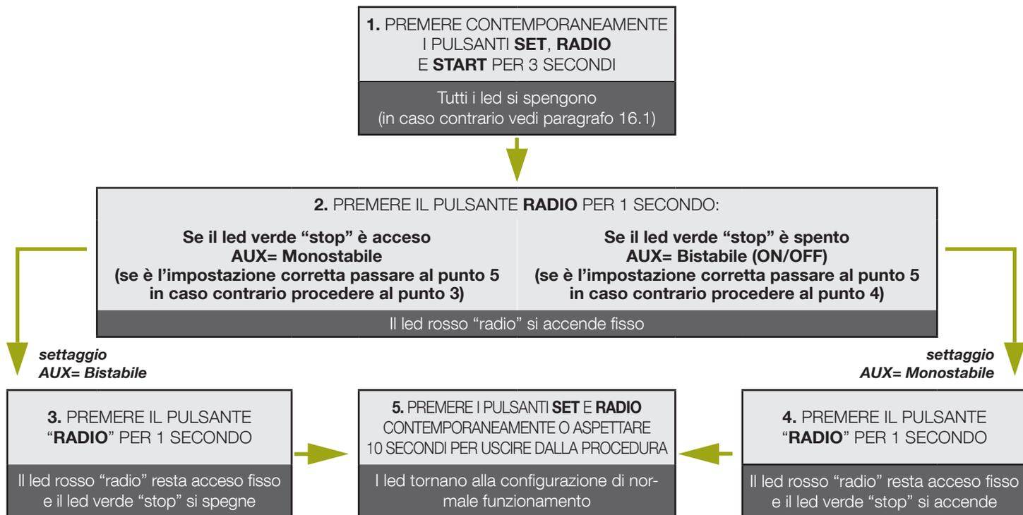
**⚠ Per comandare il contatto AUX impostato come luce di cortesia è necessario registrare un radiocomando con la procedura di paragrafo 13.1 e collegare un relé (vedi paragrafo 13).**
