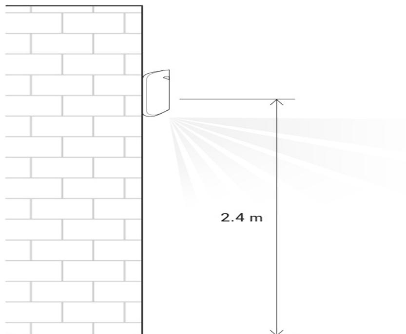
L'installazione del rilevatore a un'altezza diversa da quella consigliata restringe l'area di rilevamento e può influire sulla qualità del rilevamento del movimento.
