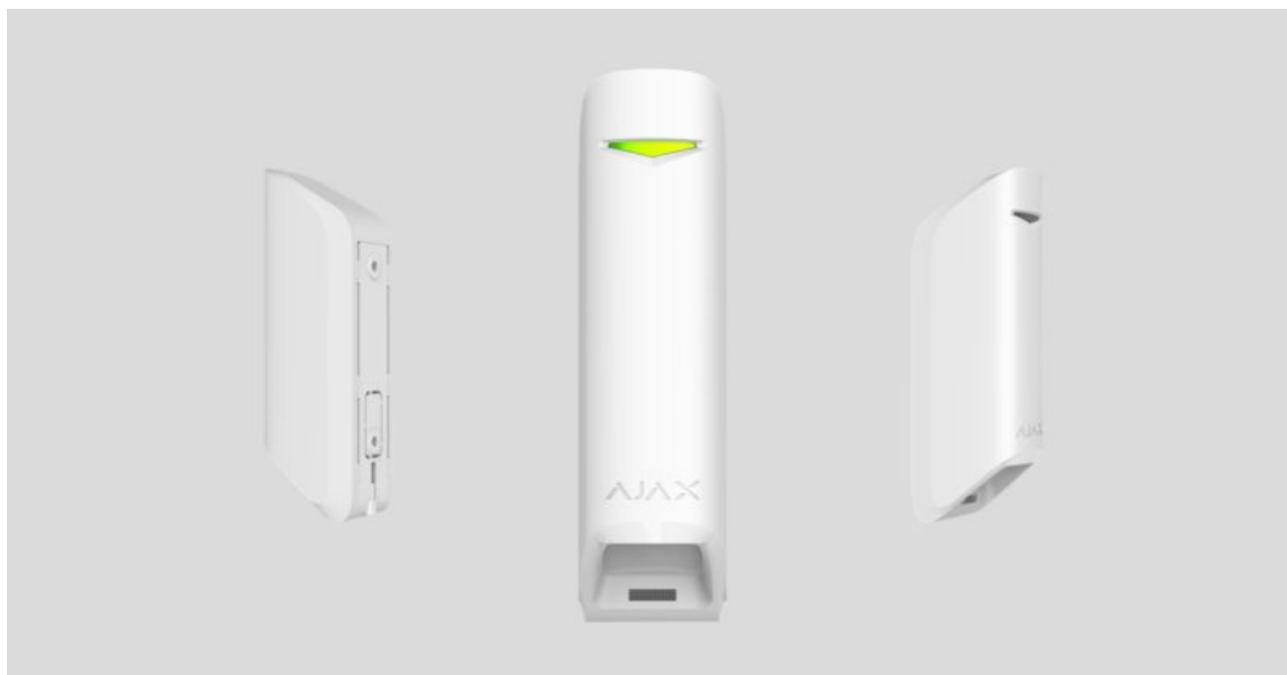
**MotionProtect Curtain** è un rilevatore di movimento a tenda senza fili. Il rilevatore ha un angolo di rilevamento orizzontale stretto ed è progettato per il controllo del perimetro degli interni: protezione di finestre, porte e altri ingressi e uscite dell'edificio sorvegliato. MotionProtect Curtain riconosce il movimento fino a una distanza di 15 metri.
