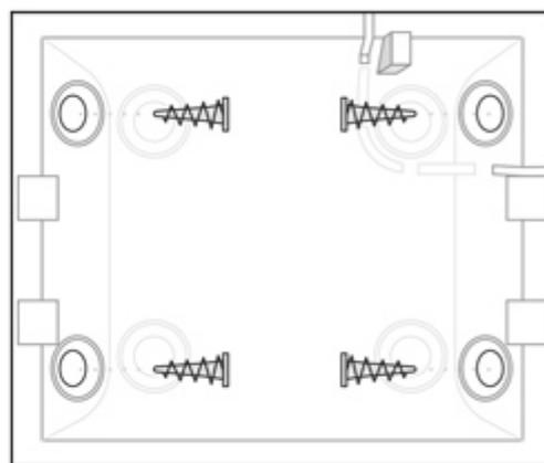
1. Fissare il pannello SmartBracket alla superficie usando le viti in dotazione, in almeno due punti (uno dei quali deve essere sopra il tamper). Se si sceglie di usare altri metodi di fissaggio, si prega di assicurarsi che non danneggino o deformino il pannello.
