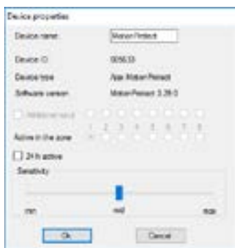
FIGURA 5. Il menu delle proprietà del sensore consente di registrare il sensore nella zona
