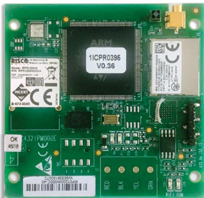
Il Modulo di comunicazione Wi-Fi è un modulo ad innesto che permette ai sistemi ProSYS Plus e Agility di collegarsi a una rete IP attraverso un router con accesso Wi-Fi.
