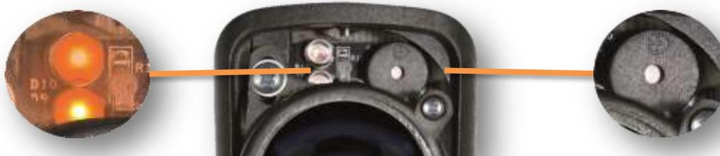
4. Orientare l'ottica posta nella colonna TX verso quella RX, verticalmente ed orizzontalmente agendo sulle viti di regolazione (orizzontale e verticale) fino a trovare il massimo allineamento. La condizione di massimo allineamento sarà raggiunta quando i led ad alta intensità saranno accesi fissi ed il buzzer emetterà un suono continuo.
