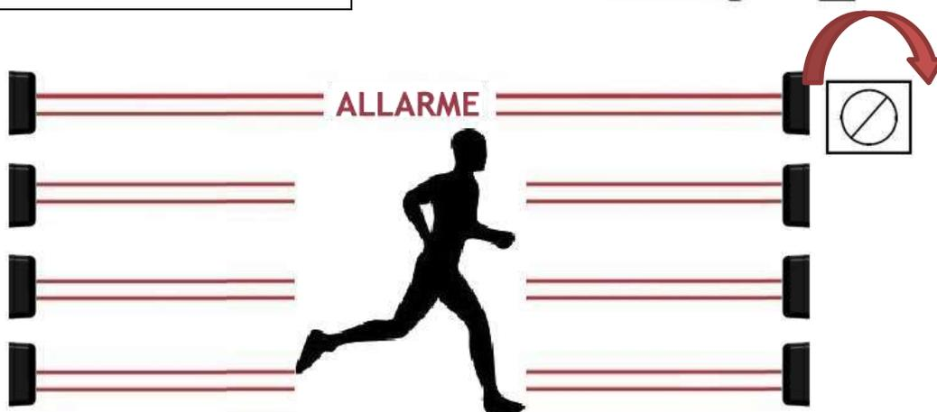
Regolando il potenziometro in senso orario si diminuisce il tempo di intervento fino a 50ms. In questa condizione si garantisce l'allarme di una persona che attraversa correndo alla massima velocità la barriera
