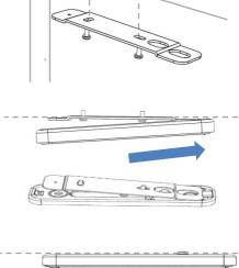
3. Una volta inserito e posizionato in modo saldo, riportate la base del sensore in posizione orizzontale facendola combaciare alla piastra di fissaggio.
