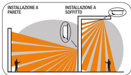
Dove non sia possibile un'installazione delimitata da un muro o un pavimento è preferibile installare il sensore inclinato di 30° utilizzando lo SNODO HUBP.
