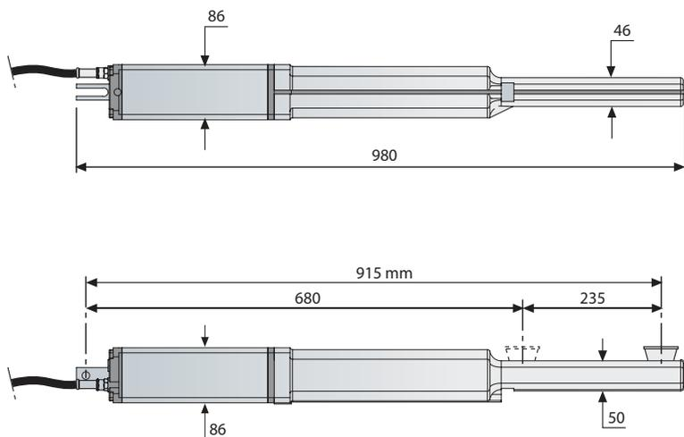
L'apricancello **HINDI 880 SPRINT** è un gruppo oleodinamico particolarmente indicato per cancelli a battente di medie dimensioni, con ante fino a 2,3 metri; è un'automazione semplice da installare grazie ai due attacchi con spinotti da applicare sulle ante e sui pilastri di sostegno, che permettono l'apertura e la chiusura delle ante stesse.
