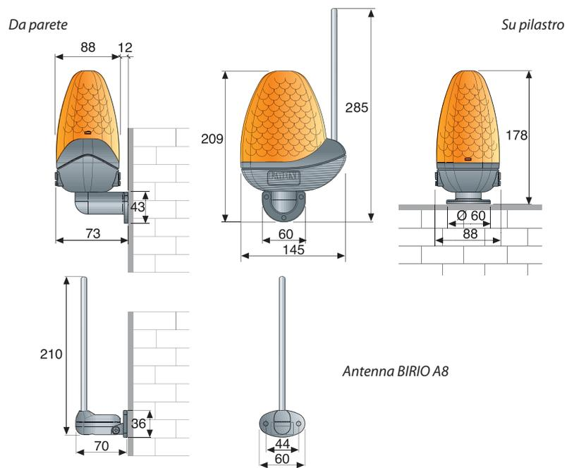
**Miri 4** è un dispositivo di segnalazione visiva a led con tensione di alimentazione 24 Vac/dc oppure 230V, studiato per indicare il movimento di un ingresso motorizzato.
