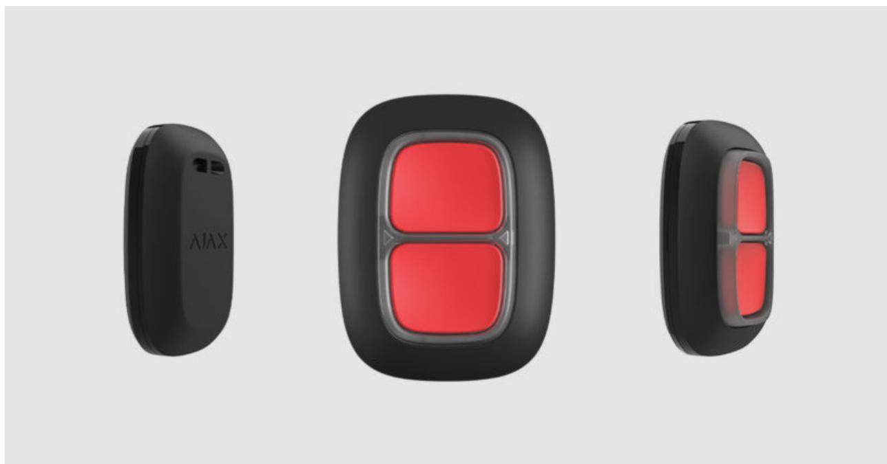
**DoubleButton** è un pulsante di emergenza senza fili con protezione contro pressioni accidentali. Il dispositivo comunica con un hub attraverso il protocollo radio Jeweller criptato e compatibile solo con i sistemi di sicurezza Ajax. Il campo di comunicazione della linea di vista è fino a 1.300 metri. DoubleButton funziona usando la batteria preinstallata fino a 5 anni.
