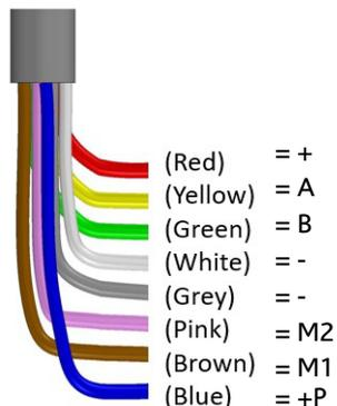
Di seguito un esempio di installazione e la tabella dei collegamenti dei terminali M1 e M2 della tastiera ergo-X mediante il cavo non schermato 8x0,22mm. I due terminali hanno le seguenti caratteristiche:
