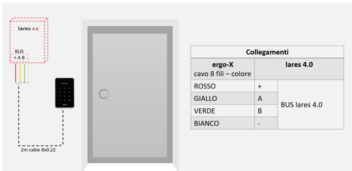
Dettaglio del cavo non schermato 8x0.22mm:
