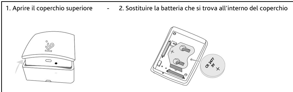
**Nota:** a temperature inferiori a +5 °C il micro poli può segnalare batteria bassa erroneamente. Il funzionamento al di sotto di +5 °C riduce sensibilmente la durata utile della batteria. Avvertenza: Inserire la batteria rispettando la polarità indicata. Sostituire esclusivamente usando batterie al lithium CR-2477 3V.
