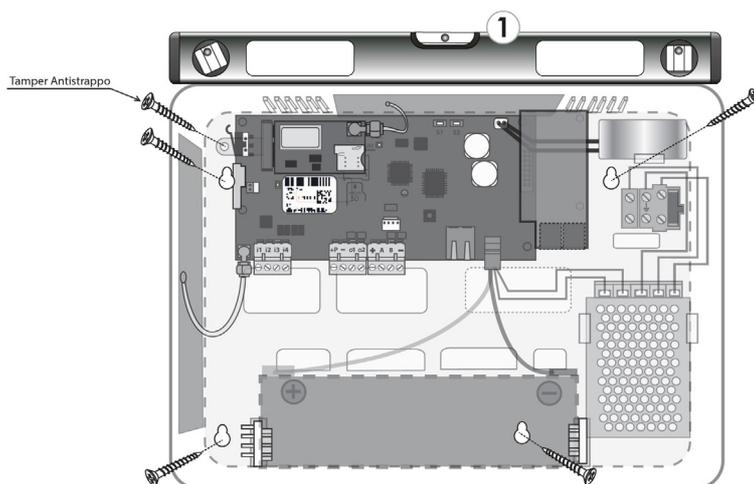
6. Installare e collegare la batteria da 12V / 2 Ah come indicato in figura.
