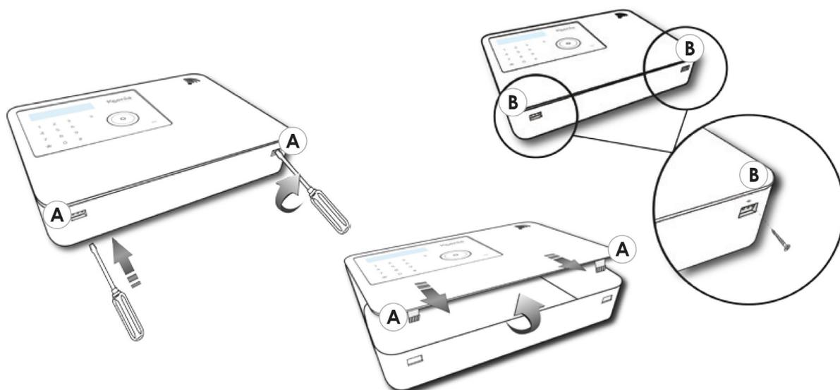
4. Forare in corrispondenza dei punti di fissaggio e ancorare la centrale alla parete utilizzando le viti da 5 mm in dotazione contenute nella confezione.
