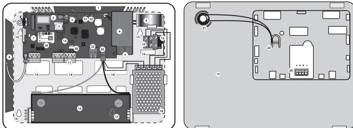
Per installare correttamente il box plastico alla parete utilizzare le viti Ø 5mm (in dotazione).
