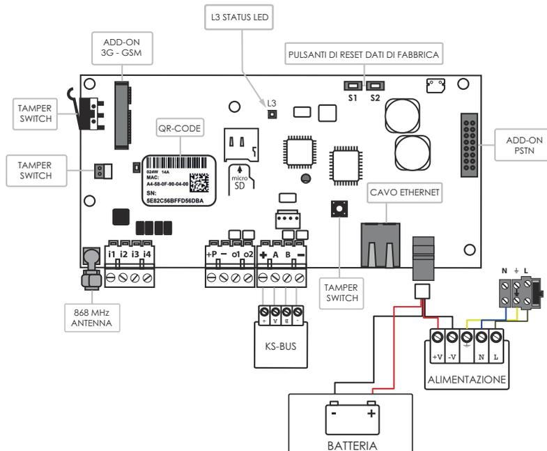
Nota1: il cavo di alimentazione fornito per il collegamento dell'alimentatore e della batteria è composto di quattro poli, i due poli non intestati vanno all'alimentatore (15 Vcc), i due intestati con faston vanno alla batteria al piombo da 12 V.
