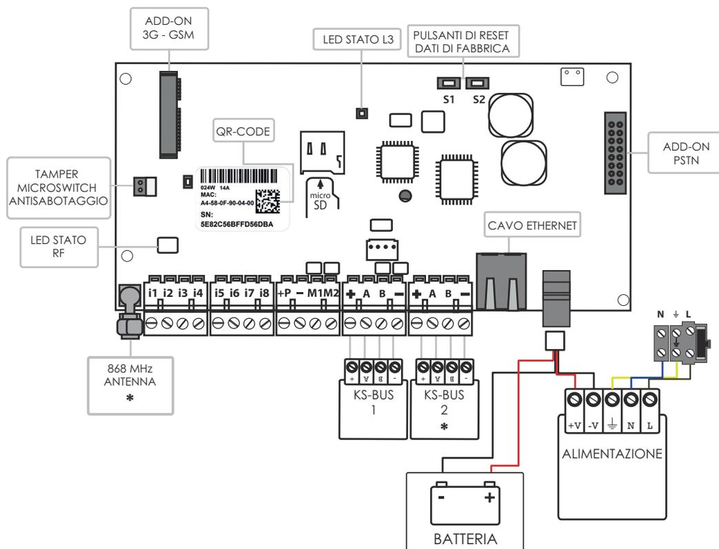
Nota1: il cavo di alimentazione (N.8 della ["- Figura 1 -" pag. 11](#)) fornito per il collegamento dell'alimentatore e della batteria è composto di quattro poli, i due poli non intestati vanno all'alimentatore (15 Vcc), i due intestati con faston vanno alla batteria al piombo da 12 V.
