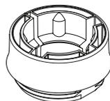
5. Montare il dispositivo sulla valvola e serrarlo ruotando la protezione in senso orario.
